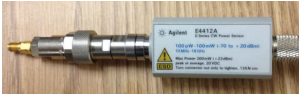
Figure 3.53: Photo de la sonde de puissance utilisée pour calibrer la puissance du NVNA [5].
