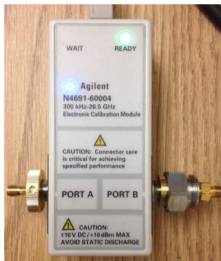
Figure 3.54: Photo du module de calibrage électrique appelé ECal [5].
