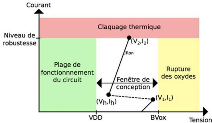
**Figure 1.5:** Fenêtre de conception d'une protection ESD
