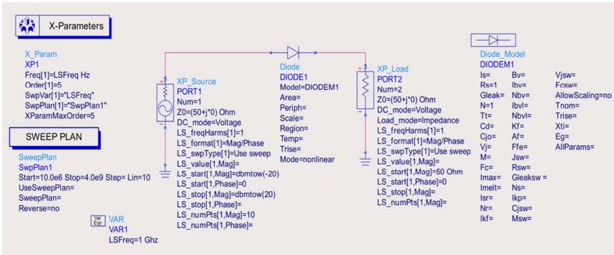
Figure 3.56: Modules et montages utilisés pour la simulation de paramètres [X] sur une diode.
