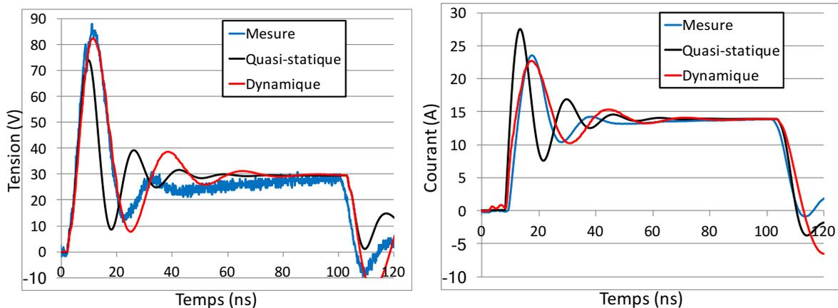
**Figure 2.54:** Comparaison de la tension et du courant mesuré sur la protection LIN-GND avec une capacité de 1nF en parallèle aux résultats de simulation du modèle quasi-statique et dynamique pour une injection 800V TLP. (LIN A)
