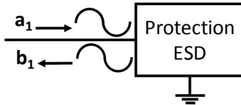
Figure 3.14: Représentation dipôles d'une protection ESD.
