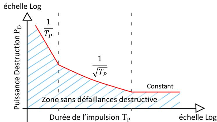
Figure 4.2: Courbe Wunsch et Bell du niveau de robustesse en puissance  $P_D$  en fonction de la durée de l'impulsion  $T_p$  en double échelles logarithmiques.
