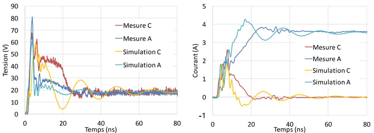
**Figure 2.60:** Mesure et simulation obtenues pour la protection LIN-GND du LIN C et du LIN A soumis à une injection TLP de 200V.
