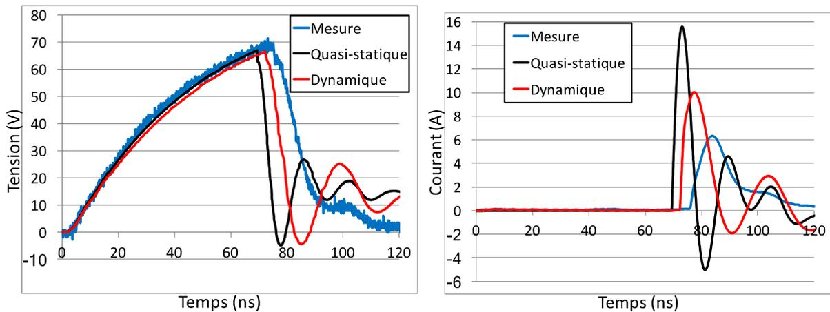
**Figure 2.52:** Comparaison de la tension et du courant mesuré sur la protection LIN-GND avec une capacité de 1nF en parallèle aux résultats de simulation du modèle quasi-statique et dynamique pour une injection 100V TLP. (LIN A)
