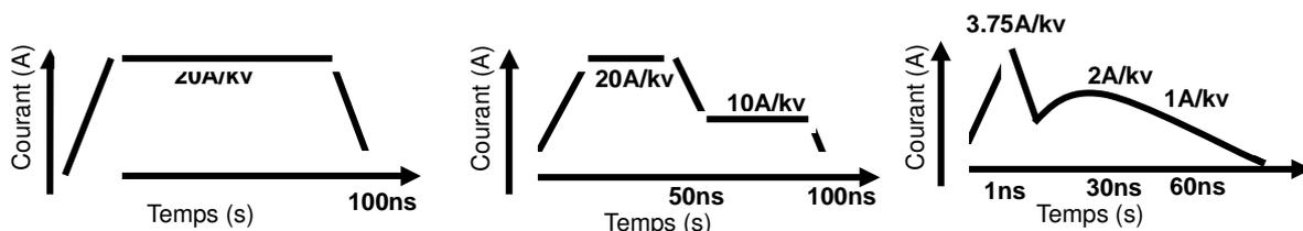
**Figure 4.24:** Différentes formes d'ondes appliquées sur le LIN pour la validation des modèles. De gauche à droite, le TLP, le MR-TLP et le standard HMM.
