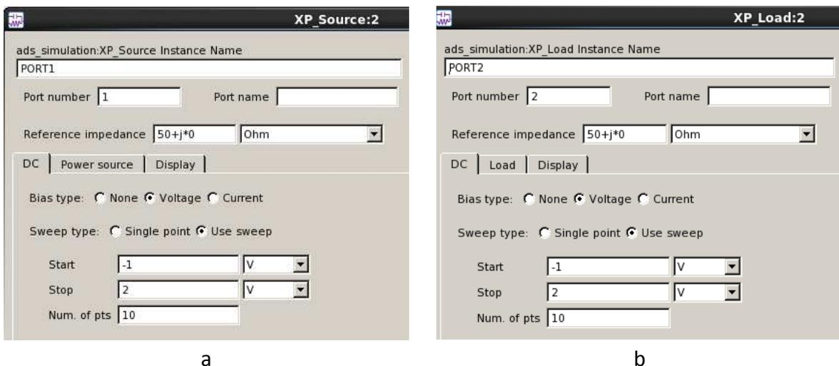
Figure 3.57: Configuration du port 1 (a) et du port 2 (b) pour la simulation de paramètres X.
