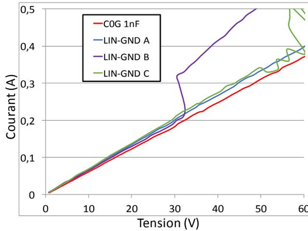
**Figure 2.46:** La caractéristique I(V) du condensateur COG de 1nF seul est confrontée aux courbes I(V) obtenues pour la protection LIN-GND des fabricants nommés A, B et C en parallèle du condensateur.
