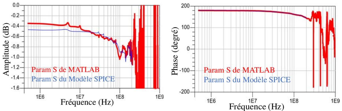
Figure 3.39: Amplitude et phase du paramètre S11 du composant CI2
