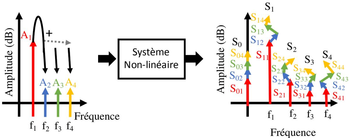
**Figure 3.49:** Réponse spectrale d'un système non linéaire soumis à un signal de forte amplitude sur lequel est rajouté un signal de faible amplitude.
