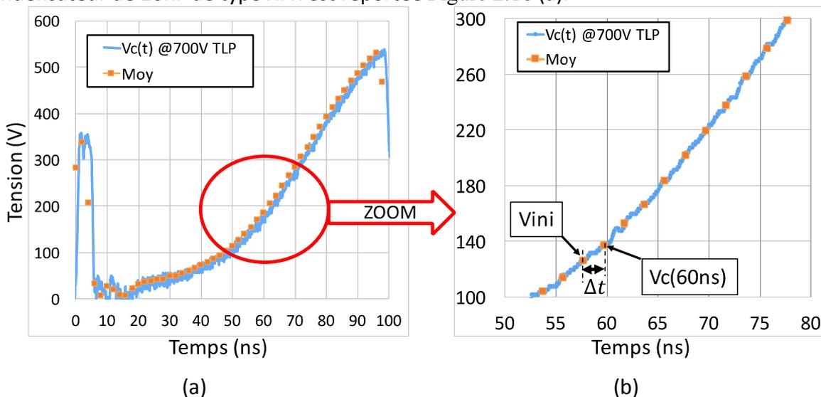
**Figure 2.16:** (a) Tension aux bornes du condensateur X7R de 10nF soumis à une injection de 700V TLP obtenue par la méthode TLP-TDR. (b) Zoom sur une portion du signal.
