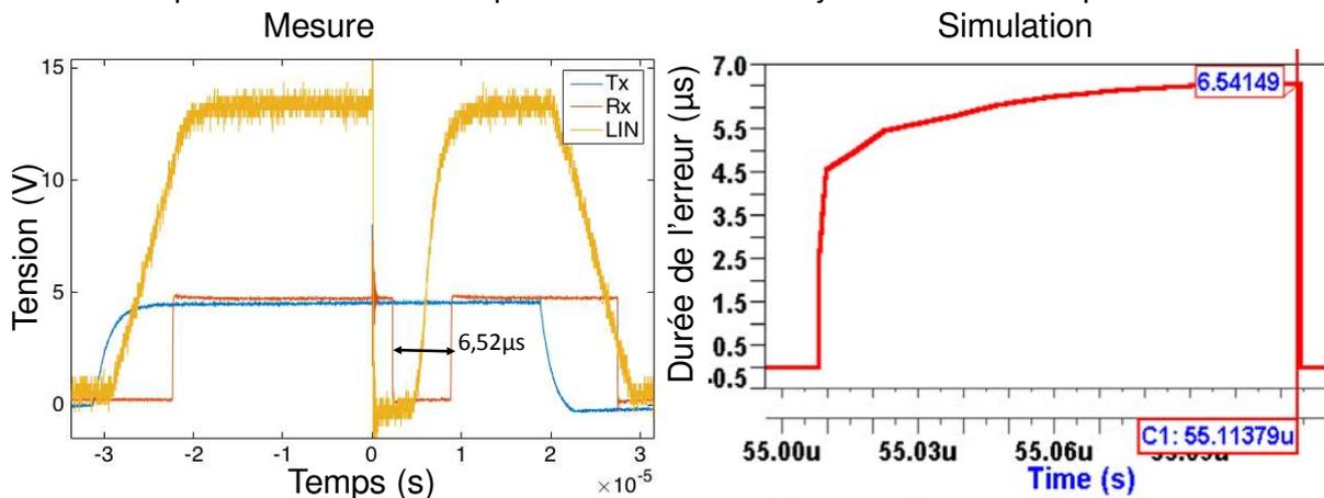
Figure 4.25: Mesure et simulation du comportement d'un composant LIN soumis à une injection TLP de 100ns et 16A.
