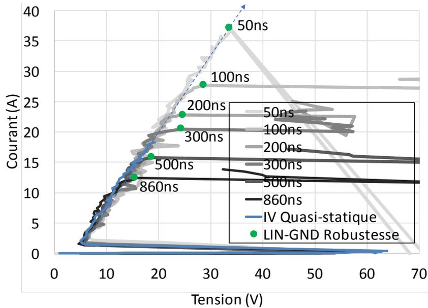
**Figure 4.8:** Courbes IV quasi-statiques confrontées aux points de défaillances obtenus sur la protection LIN-GND du LIN B.
