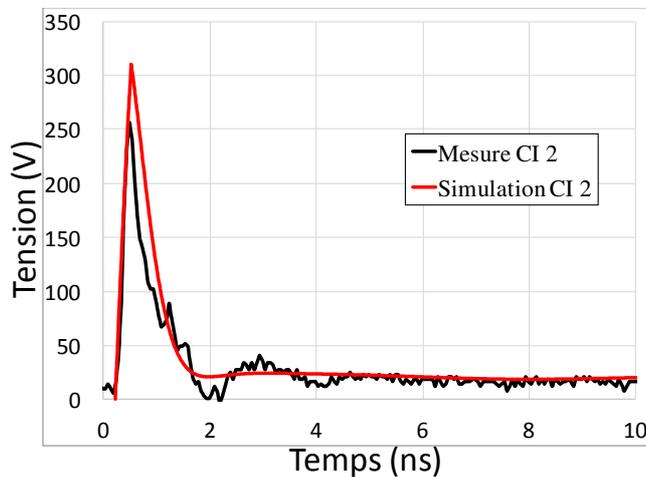
**Figure 3.41:** Zoom sur le comportement transitoire de la mesure sur le CI 2 et du modèle SPICE généré.
