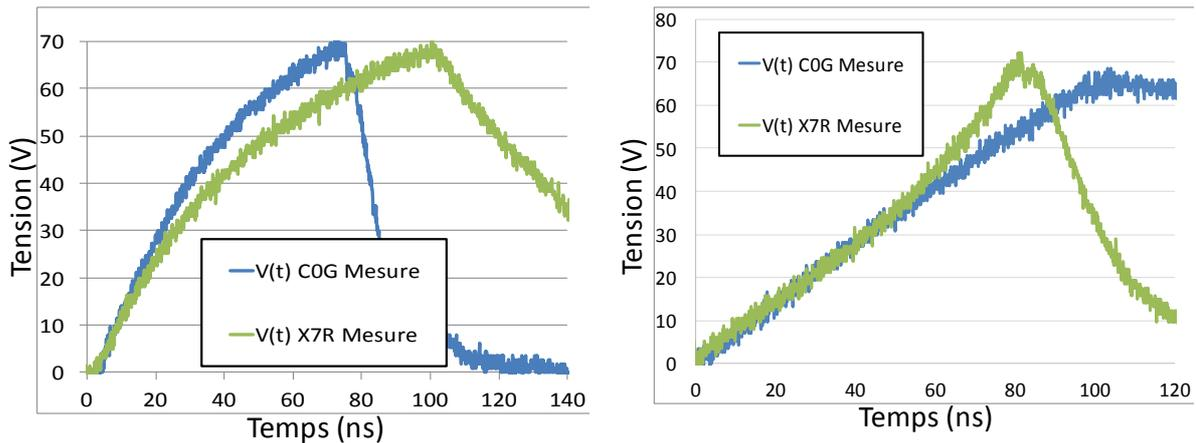
(a) Condensateur de 1nF, stress 100V TLP (b) Condensateur de 10nF, stress 400V TLP
