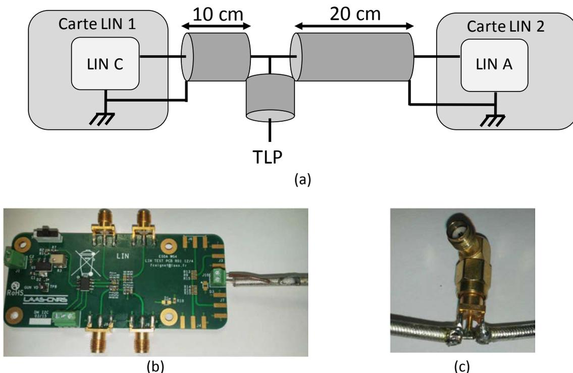
**Figure 2.57:** Injection TLP sur la communication LIN entre deux cartes (a). Photo des connexions des cartes LIN au câble coaxiale (b), et du connecteur d'injection(c).
