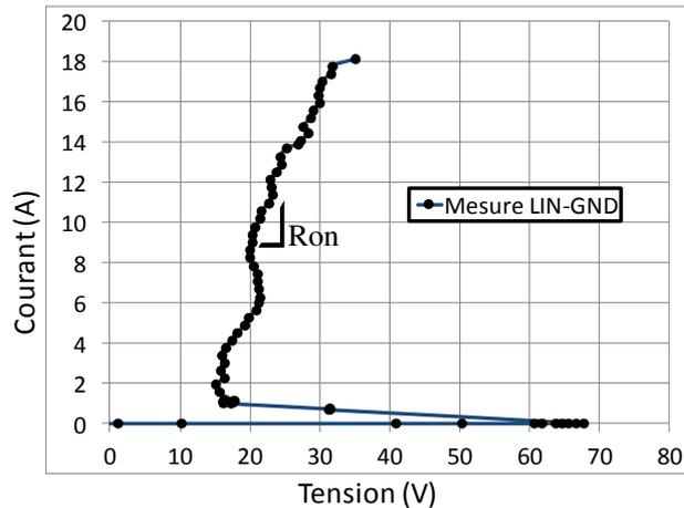
Figure 2.22: Courbe I(V) quasi-statique de la protection LIN-GND
