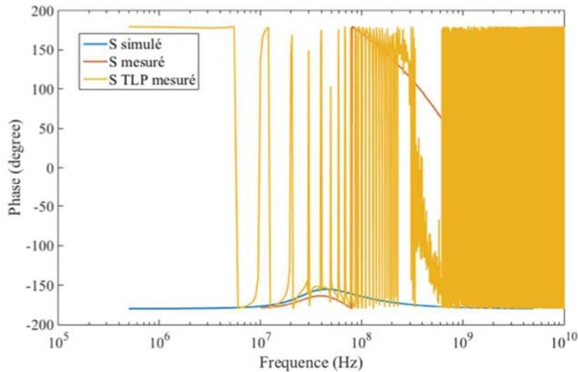
**Figure 3.31:** Comparaison des paramètres [S] obtenus en simulation sur le circuit RLC « S simulé », aux paramètres [S] obtenus à partir d'un VNA « S mesuré », ainsi qu'aux paramètres [S] extraits via le code Matlab à partir des mesures TLP « S TLP mesuré ».
