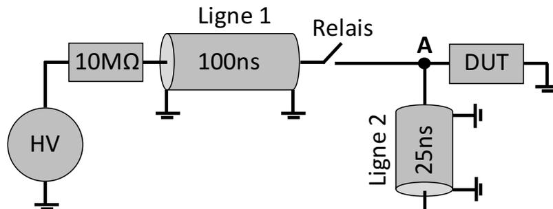
**Figure 3.64:** Schéma électrique du premier TLP2P réalisé
