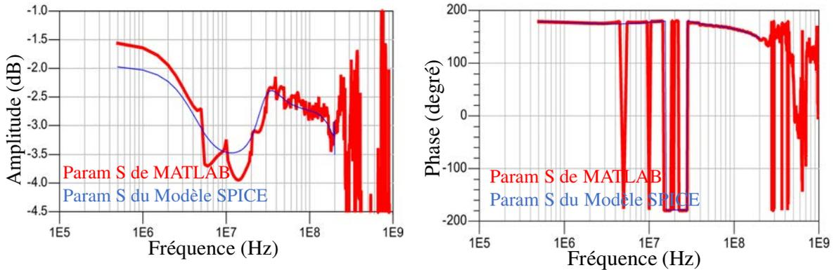
**Figure 3.42:** Amplitude et phase du paramètre S11 du composant CI 3.
