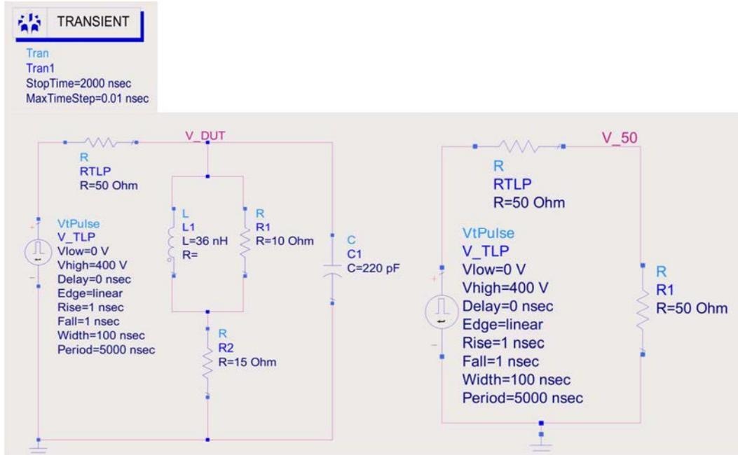
**Figure 3.22:** Simulation sur le logiciel ADS d'une injection TLP de 400V sur le circuit RLC à gauche et sur une terminaison 50Ω à droite.
