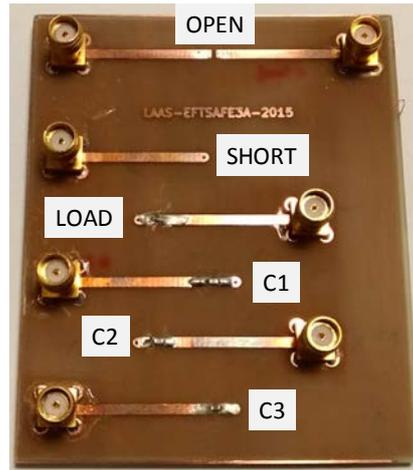
**Figure 2.6:** Carte de test pour les condensateurs MLCC.
