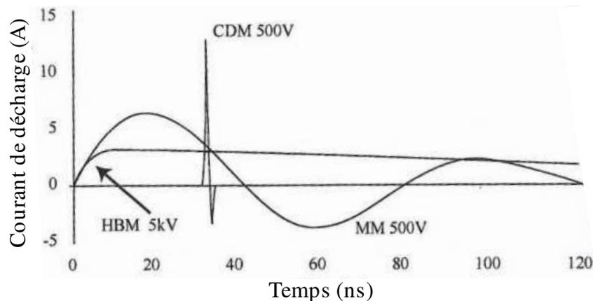
**Figure 1.8:** Représentations temporelles des formes d'onde obtenues suite à une décharge sur un court-circuit des modèles HBM, MM et CDM.
