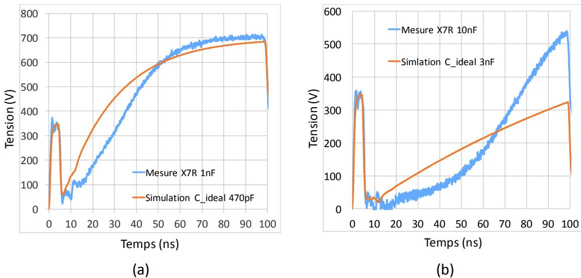
**Figure 2.15:** (a) Comparaison entre la tension mesurée aux bornes d’une X7R de 1nF et la simulation de la tension aux bornes d’un condensateur idéal de 470pF tous deux soumis à une injection de 700V TLP. (b) Comparaison entre la tension mesurée aux bornes d’une X7R de 10nF et la simulation de la tension aux bornes d’un condensateur idéal de 3nF tous deux soumis à une injection de 700V TLP
