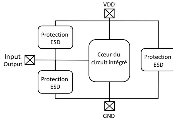
Figure 1.6: Réseau de protection d'un circuit intégré
