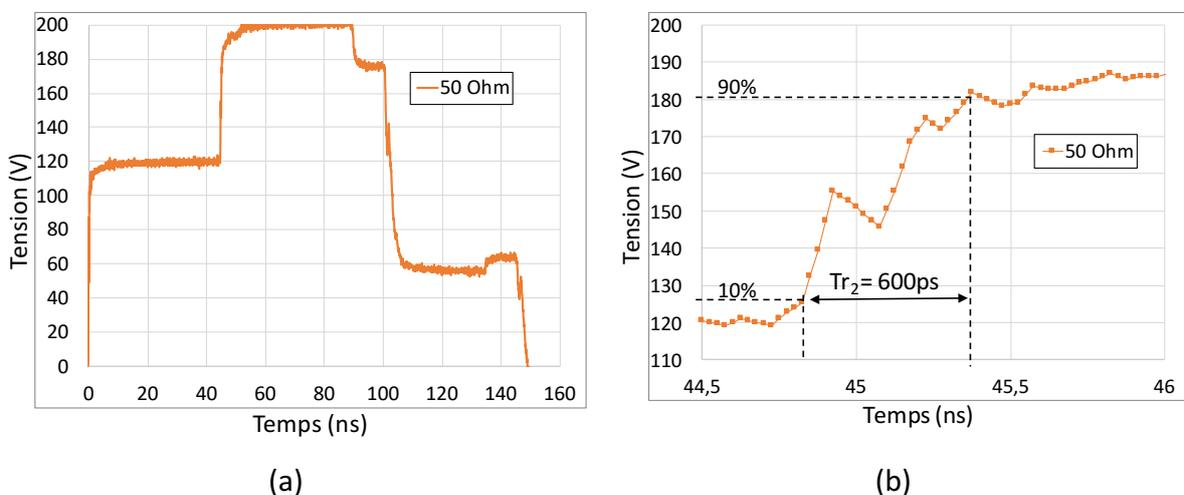
**Figure 3.65:** (a) Décharge du générateur TLP2P dans une impédance de  $50\Omega$ . (b) Zoom sur le second front de l'impulsion TLP2P.
