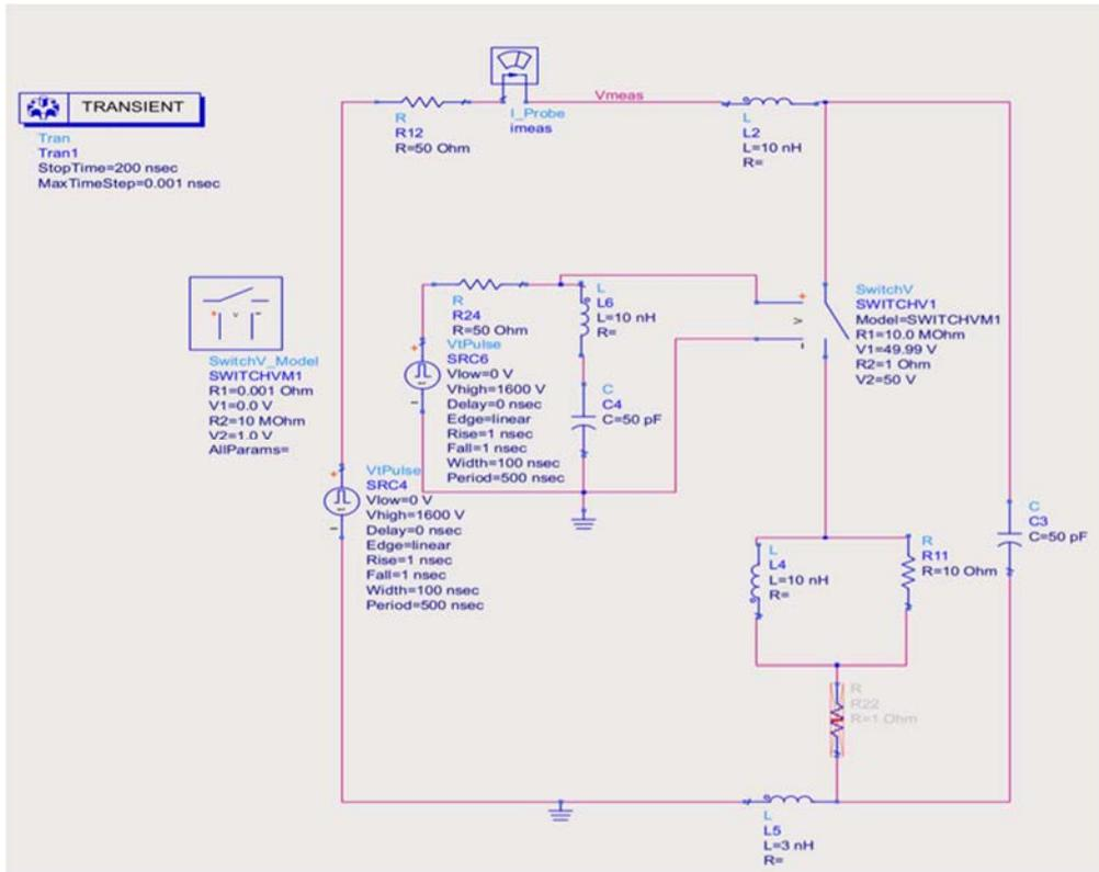
**Figure 3.9:** Simulation sur le logiciel ADS d'une injection TLP sur le modèle comportemental dynamique de la protection LIN-GND.
