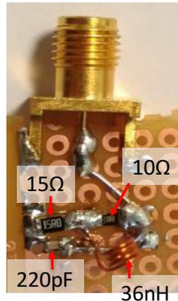
Figure 3.26: Photo du circuit RLC réalisé
