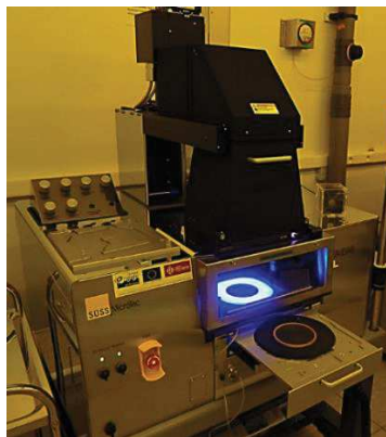
Figure III. 12 - Appareil de photolithographie du LAAS : MA6 Gen4.
