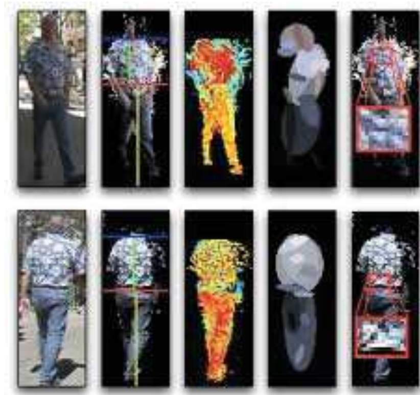
FIGURE 3.3 – Exemples du descripteur SDALF [Farenzena 2010]. Les colonnes présentent respectivement : deux images de la même personne, les axes de symétrie et asymétrie, la projection de l’histogramme couleur HSV, les Maximally Stable Color Regions (MSRC) et les Recurrent Highly Structured Patches (RHSP).
