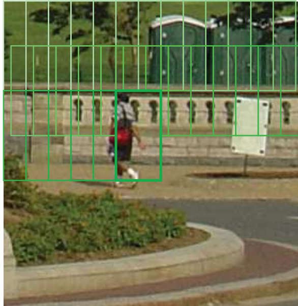
FIGURE 1.6 – Exemples de fenêtres glissantes sur une image 769 \times 516 pixels issue de la base INRIA.
