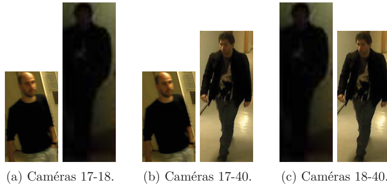
FIGURE 4.4 – Exemple d'appariement par NCR sur SDALF sur la base HDA. L'identité 10 de la caméra 17 est appariée avec l'identité 2 de la caméra 18. L'identité 10 de la caméra 17 est appariée avec l'identité 1 de la caméra 40. L'identité 2 de la caméra 18 est appariée avec l'identité 1 de la caméra 40.
