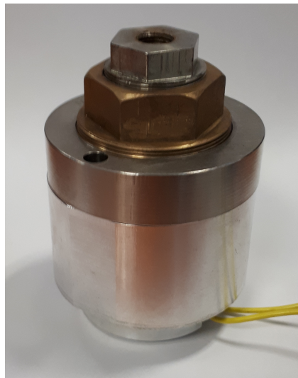
FIGURE 3.13 – Photo de la bombe manométrique initiée par micro-inflammeurs
