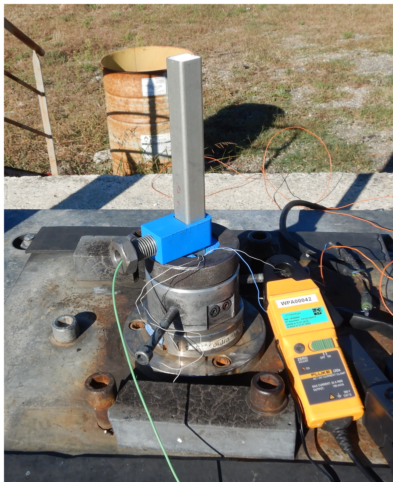
FIGURE 3.24 – Dispositif pour tir semi-dynamique d'impulseurs triples
