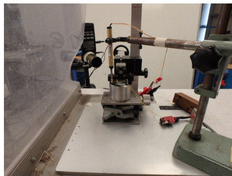
FIGURE 2.17 – Schéma de principe (haut) et photo (bas) du dispositif d'essai d'allumage
