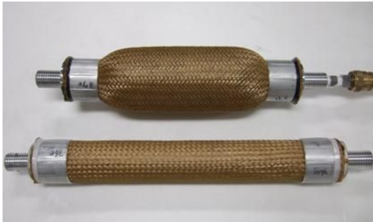
FIGURE 3.9 – Muscle artificiel pneumatique de McKibben
