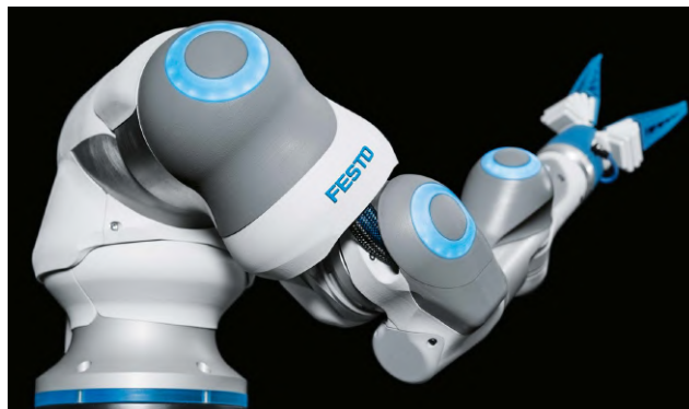
FIGURE 3.7 – Bras manipulateur BionicCobot pneumatique à 7 degrés de liberté, conçu par l’entreprise Festo.
