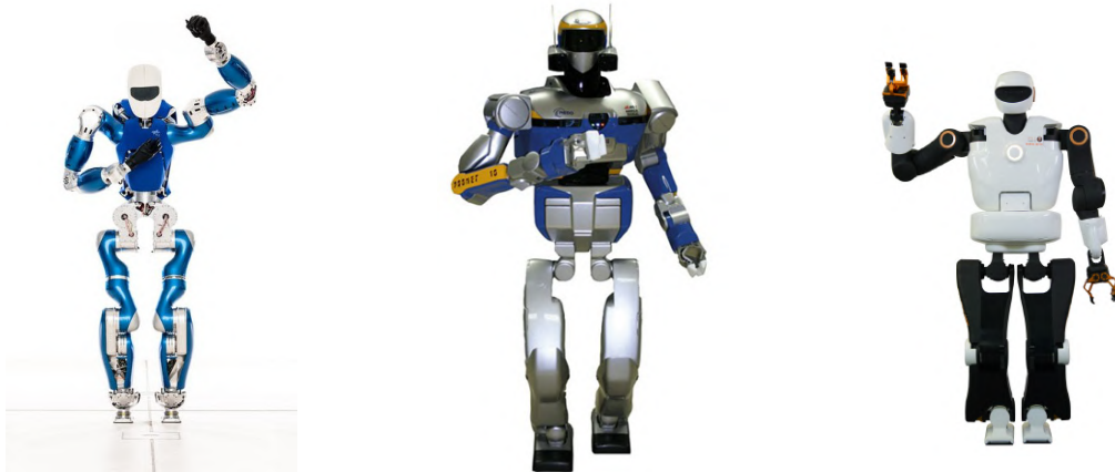
FIGURE 1.3 – Robots humanoïdes exploitant un système d'actionnement électrique et des réducteurs à ondes de déformation. Gauche : TORO conçu par le DLR, Centre : HRP2 développé par Kawada Robotics, Droite : Talos conçu par Pal-Robotics
