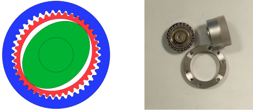
FIGURE 1.2 – Schéma de fonctionnement d'un réducteur à onde de déformation (harmonic drive) et photo du système réel
