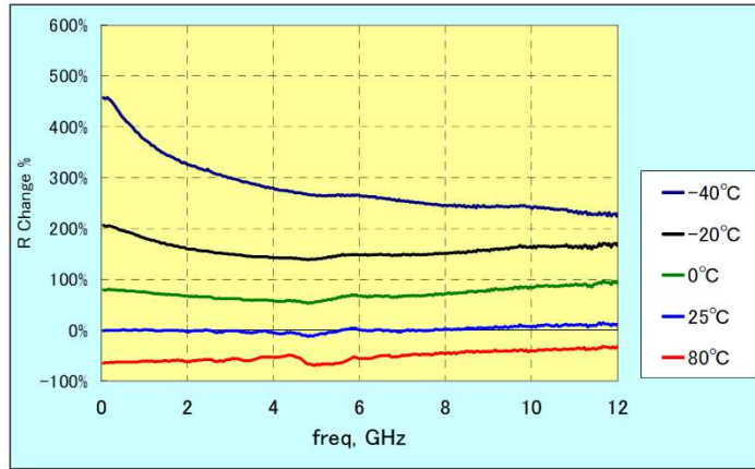
Figure 58. Variation relative de la valeur de la résistance en fonction de la fréquence d'utilisation pour différentes températures. Extrait de la datasheet du composant SUSUMU HTF 0805 series .
