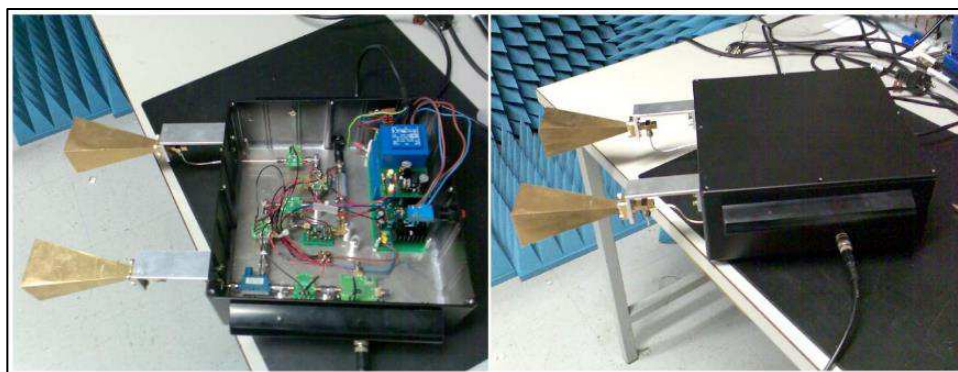
Figure 75. Radar FM-CW 30GHz utilisé pour les mesures préliminaires.
