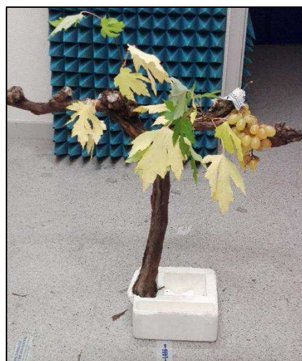
Figure 92. (a) Photographie du pied de vigne avec les feuilles et la grappe de raisin (b) Image radar 2D dans le plan (\theta, \phi) pour R=1,275m (soit 17 fois la résolution en profondeur d ) pour les quatre couplages. Echelle : -60dB (bleu) à -40dB (rouge).
