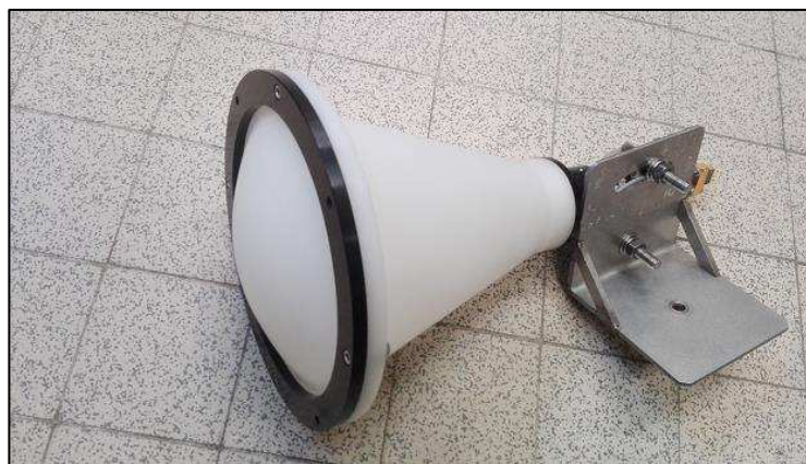
Figure 156. Antenne cornet avec lentille utilisée en transmission à 24GHz (datasheet Ducommun)
