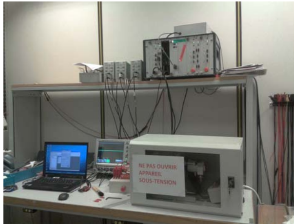
FIGURE 6.6 – Photographie de l'essai de caractérisation d'un moteur partiellement court-circuité.
