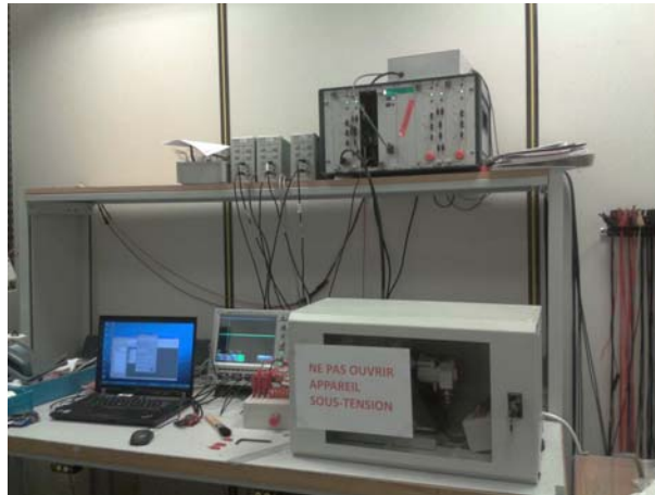
FIGURE 6.6 – Photographie de l'essai de caractérisation d'un moteur partiellement court-circuité.
