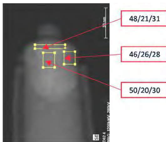
Figure III-28 : Quantifications localisées par analyse EDX au sein de l'alliage Ni-GaAs formé au sommet des nanofils.
