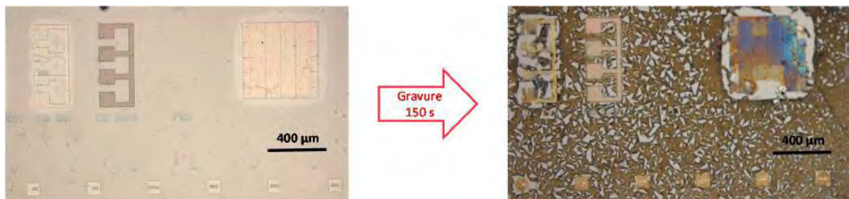
Figure V-30 : Microscopie optique de la surface de l'échantillon avant et après une gravure de Cr. L'état de la surface en dehors de la HSQ est mauvais et le GaAs sur lequel repose le dispositif est probablement gravé.
