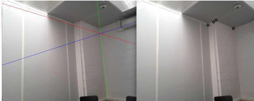
FIGURE 5.17 – A gauche, une hypothèse respectant certaines conditions. A droite, les coins fins détectés automatiquement dans l'image.
