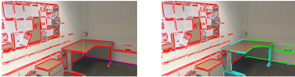
FIGURE 5.25 – La reprojection du modèle de pièce (gauche) est utilisée afin de classifier les segments 2D en fonction de leur appartenance aux différents plans (droite).
