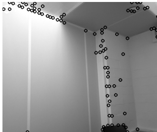
FIGURE 1.8 – Détection de points d'intérêts en utilisant la méthode GFTT de openCV.
