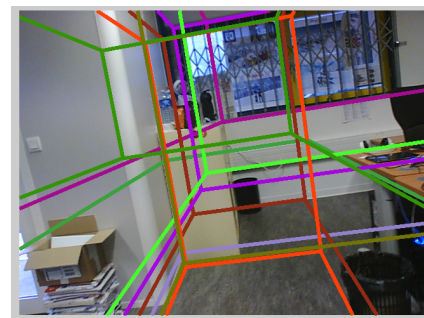
FIGURE 5.12 – Exemple des hypothèses de structures de pièces géométriquement valides obtenues par une approche exhaustive d'intersection des segments.
