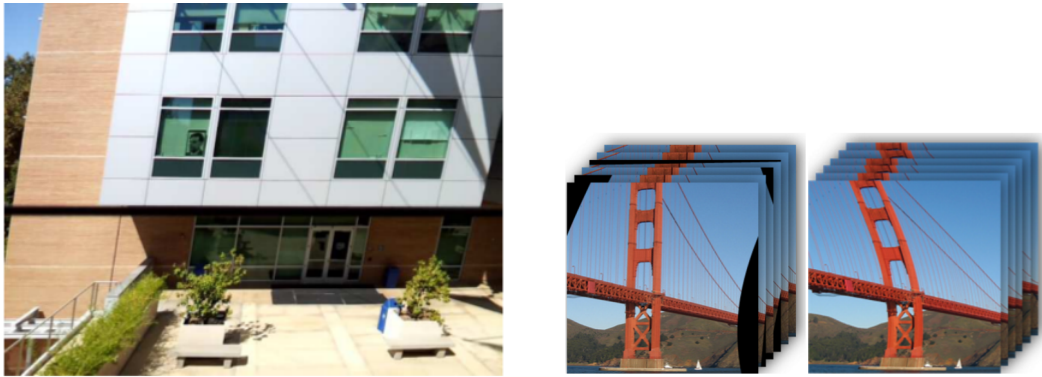
FIGURE 3.4 – Images intégrant des distorsions géométriques provoquées par l’obturateur déroulant lors de rapides mouvements relatifs entre la scène et la caméra. Images issues de [Li 2013] (gauche), et [Guo 2014] (droite).
