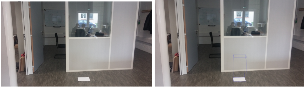
FIGURE 6.1 – Illustration de la méthode utilisant une feuille A4. La feuille détectée dans l'image d'origine (gauche) permet d'estimer la position relative de la caméra à l'échelle absolue et d'ainsi faire apparaître un objet 3D de manière réaliste dans l'image (droite), ici le modèle fil de fer d'une boîte de 50cm de hauteur.
