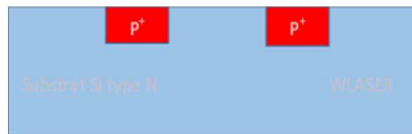
Figure A5.1 : Schéma en coupe d'un transistor MOS avant l'étape de recuit laser
