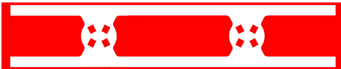
Figure C-9 : Exemple d'un environnement vaste (de l'ordre de quelques centaines de mètres) et non-convexe. Relier deux trajectoires de nettoyage des surfaces dans cet exemple peut s'avérer complexe, puisque l'algorithme doit comprendre qu'il doit aller chercher la suite derrière un mur.
