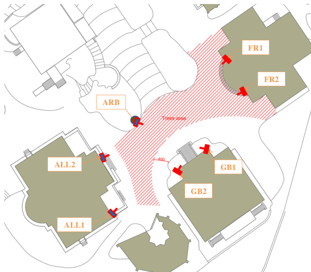
Figure D-5 : Implantation des antennes UWB Ubisense dans les Giardini.
