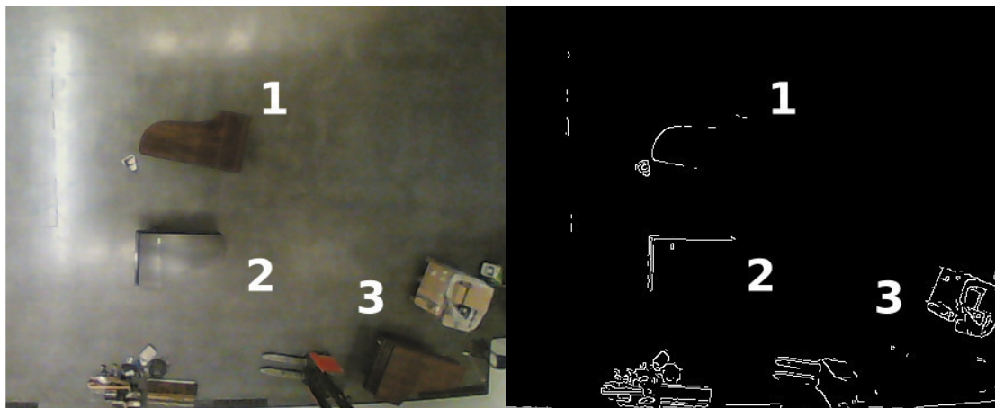
Figure B-5 : Image des caméras à gauche, sortie de l'algorithme d'extraction de contours pour cette image à droite. Les contours des machines sont bien visibles, mais ceux des pianos sont estompés par endroits, y compris pour l'œil humain.
