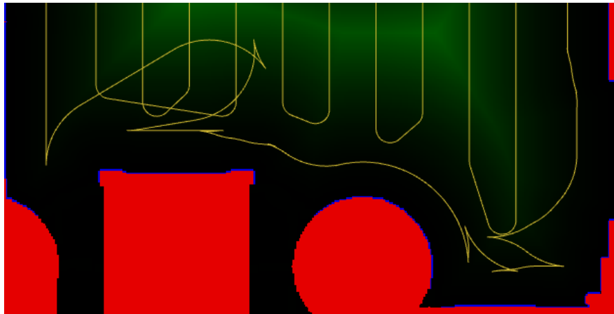
Figure C-8 : Amélioration de l'exemple de la figure C-6. Dans certains cas, la méthode de Dubins raccourcit grandement les trajectoires, mais elle n'est pas toujours applicable.
