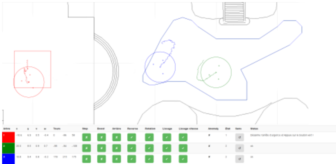
Figure D-11 : Capture d'écran de l'interface utilisateur, dans sa version avancée, en production le 9 septembre 2015. On peut y voir les AGVs ainsi que leurs traces de 10 :30 (heure à laquelle l'interface a été lancée) à 10 :45. Il y a également une table indiquant le statut de chaque AGV ainsi que certains contrôles.
