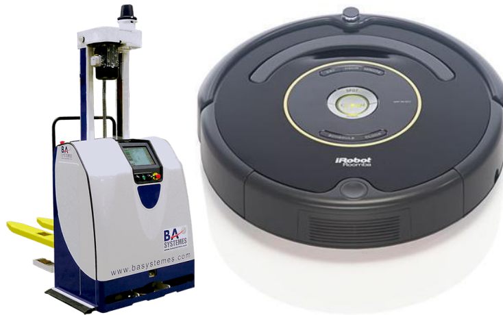
(a) Transpalette robotique conçu par l'entreprise BA Systèmes. (b) Aspirateur robotique grand public Roomba.
