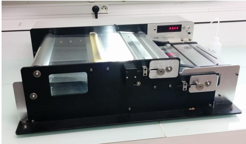
FIGURE 1.2 – Photographie d'un planimètre Li-COR employé pour réaliser des mesures de surface foliaire à l'INRA.
