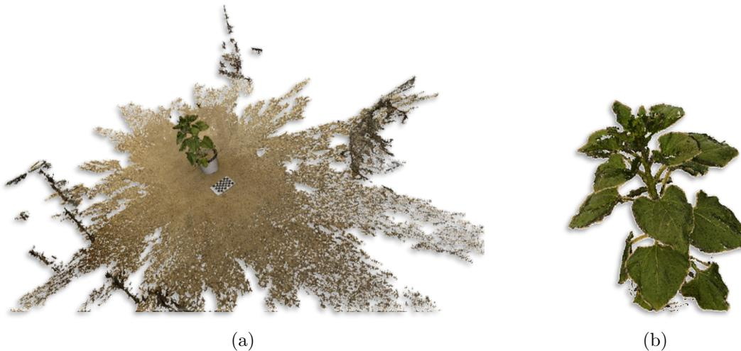
FIGURE 2.3 – Exemple de scène 3D reconstruite avec Bundler et CMVS avant filtrage de l’arrière-plan (a) et après filtrage de l’arrière-plan (b).
