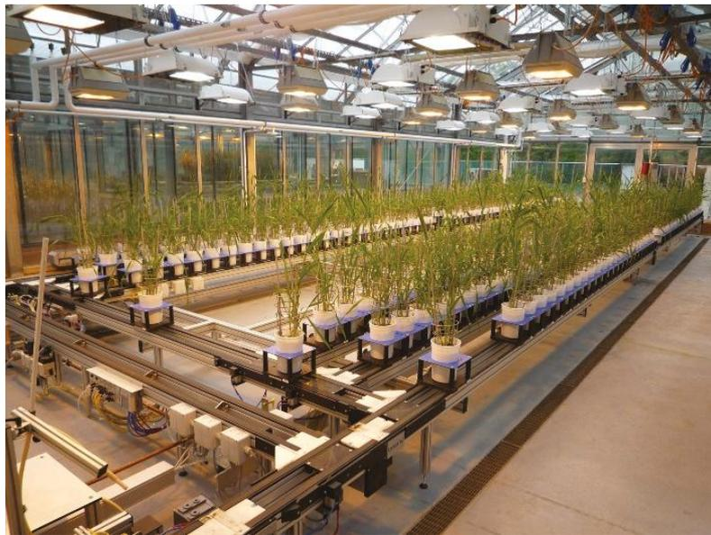
FIGURE 1.4 – Photographie de la plateforme LemnaTec employée dans [Hartmann *et al.* 2011] équipée de convoyeurs pour déplacer les plantes dans des cabines d'acquisition.
