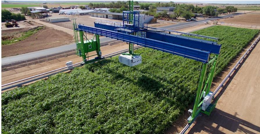
FIGURE 1.8 – Exemple du système d’acquisition Field Scanalyzer de LemnaTec capable de réaliser des acquisitions au champ sur une parcelle entière [Virlet *et al.* 2017].
