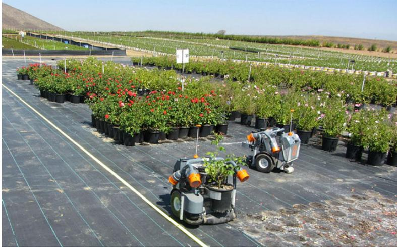
FIGURE 2.14 – Exemple du robot Harvey (HV-100) développé par l'entreprise Harvest Automation capable de déplacer des pots pour effectuer des opérations de placement.
