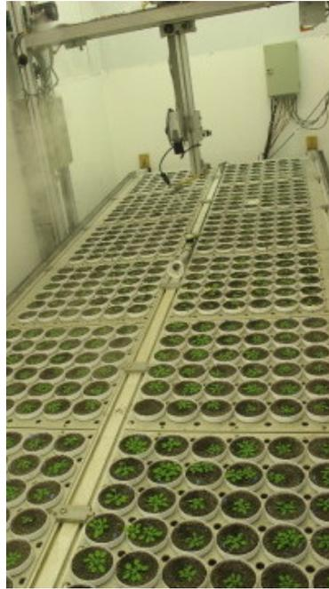
FIGURE 1.3 – Photographie de la plateforme PHENOPSIS permettant de cultiver et de réaliser des acquisitions 2D de plantes d' *Arabidopsis* sous un environnement contrôlé [Granier & Vile 2014].
