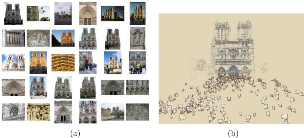
FIGURE 2.1 – Illustration de Bundler [Snavely *et al.* 2006] utilisant une collection d'images (a) et produisant une scène 3D avec la position des différentes prises de vues (b).
