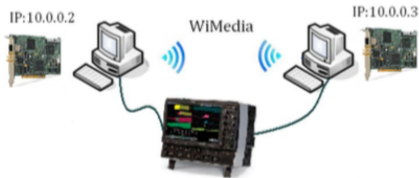
Figure 36. Banc de mesure IEEE 1588 sur WiMedia
