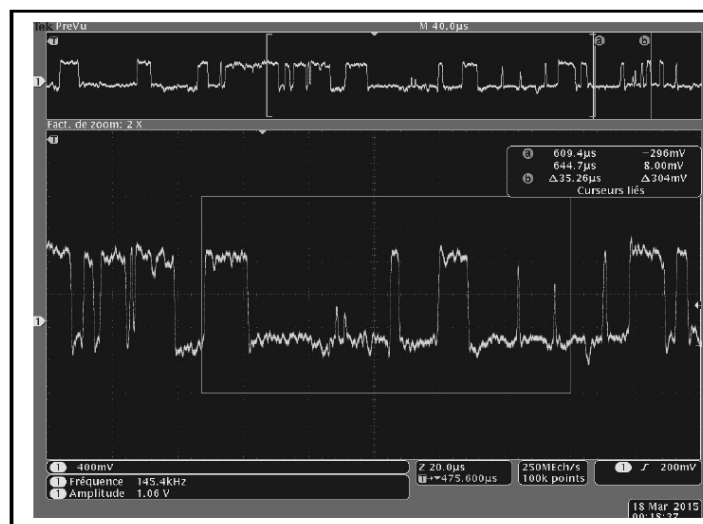
Figure II - 51. Exemple de bruit en créneaux sur l'accès de grille de D18 (dispositif stressé HTOL pendant 105 heures [135].
