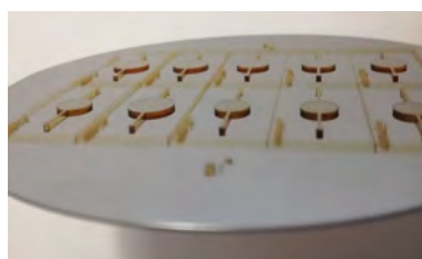
FIGURE 2.12 – Moule Si/SU8 des biopuces à optode
