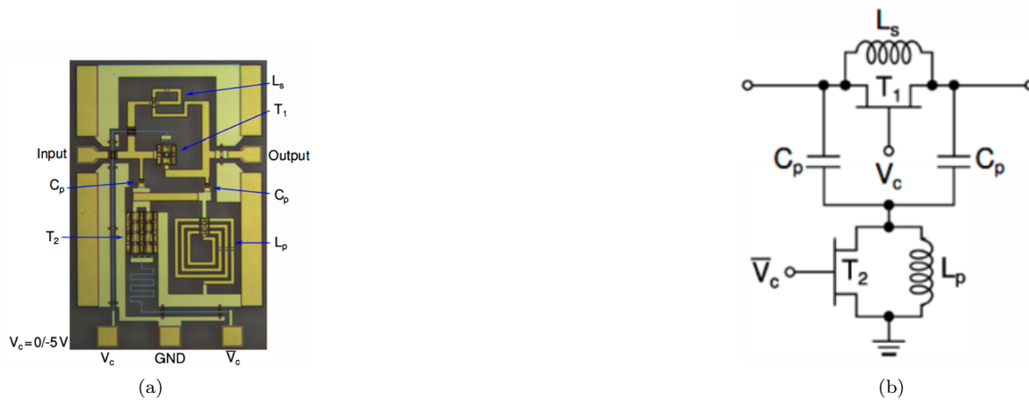
FIGURE 1.13 – Exemple de cellule de déphasage ( 22.5^\circ ) en GaN (a) circuit réalisé en bande X de dimension 0,448 \times 0,678 \text{mm}^2 (b) modélisation électrique de la topologie en T passe-bas [15].
