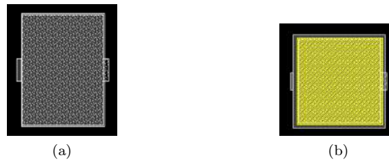
FIGURE 2.3 – Dessins des masques de capacités (a) SiO 2 (b) MIM
