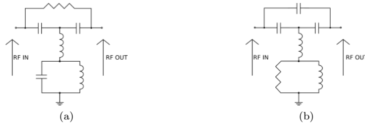
FIGURE 1.12 – Topologie en T passe-haut (a) à l'état de référence, le circuit bouchon résonne (b) le circuit bouchon se comporte comme un fil vers la masse
