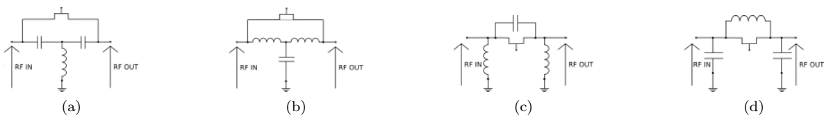
FIGURE 1.10 – Topologies à base de filtres commutés (a) en T passe-haut (b) en T passe-bas (c) en \pi passe-haut (d) en \pi passe-bas
