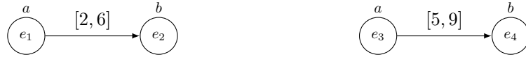
(a) La chronique élémentaire \mathcal{C}_1 = (\mathcal{E}_1, \mathcal{T}_1) avec \mathcal{E}_1 = \{e_1 = a, e_2 = b\} , \mathcal{T}_1 = \{\tau_{(1,2)} = e_1[2, 6]e_2\} . (b) La chronique élémentaire \mathcal{C}_2 = (\mathcal{E}_2, \mathcal{T}_2) avec \mathcal{E}_2 = \{e_3 = a, e_4 = b\} , \mathcal{T}_2 = \{\tau_{(3,4)} = e_3[5, 9]e_4\} .
