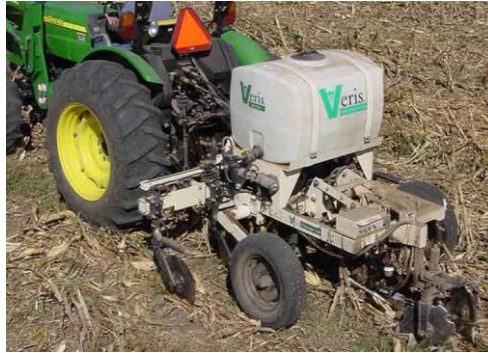
Figure 25 : Le soil pH Manager , produit commercialisé par Veris Technologies et permettant de cartographier la variabilité du pH sur une parcelle. Tiré de [114]
