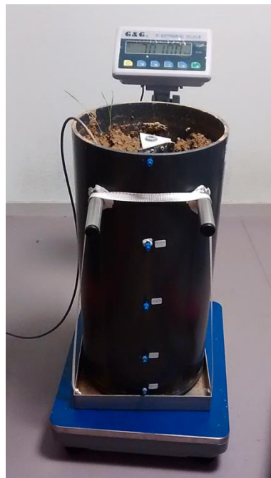
Figure 111 : Photo du banc d'essai positionné sur la balance. Les connecteurs des lysimètres apparaissent en bleu le long du tube.
