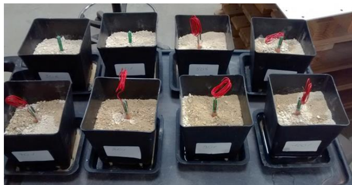
Figure 92 : Les 8 capteurs « plantés » dans les pots de sol argilo-limoneux. Le cliché a été pris quelques minutes après arrosage dans la coupelle. On note l'humidité de surface qui provient de la montée de l'eau par capillarité.
