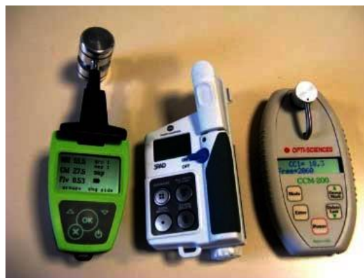
Figure 19: Capteurs de chlorophylle. De gauche à droite : Dualex 4 Scientific (FORCE-A, France), SPAD-502 (Konica Minolta, Japon) et le CCM-200 (Opti-Sciences, Etats-Unis). Tiré de [93]
