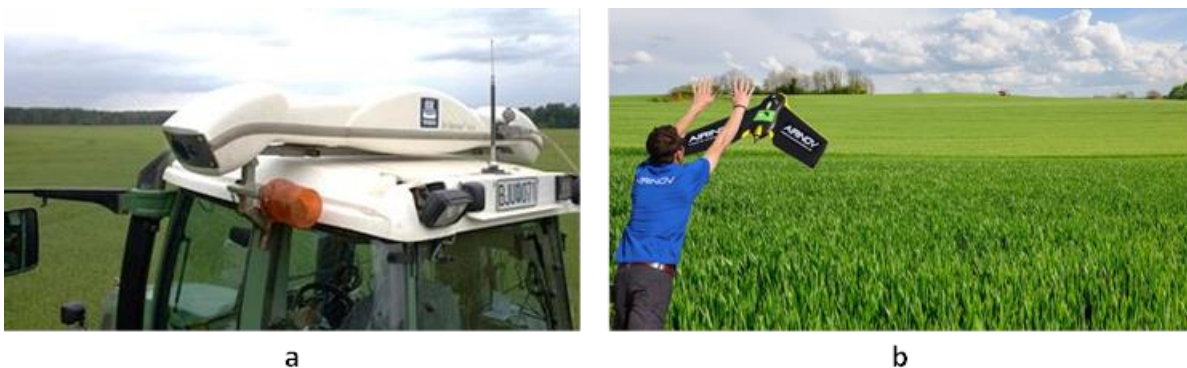
Figure 21 : (a), le Yara N-Sensor embarqué à bord d'un tracteur pour un pilotage en temps-réel de la fertilisation. Tiré de [101]. (b), lancement du drone développé par Airinov sur une parcelle. Tiré de [102]
