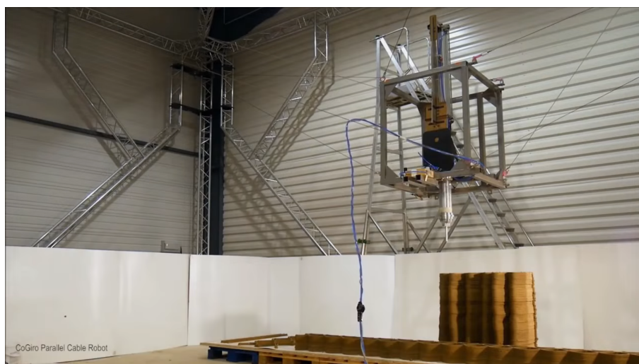
Figure 1.9 – Le RPC CoGiRo imprimant un mur [5]
