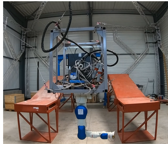
(b) Le RPC CoGiRo équipé du bras robotique Yaskawa SIA20
