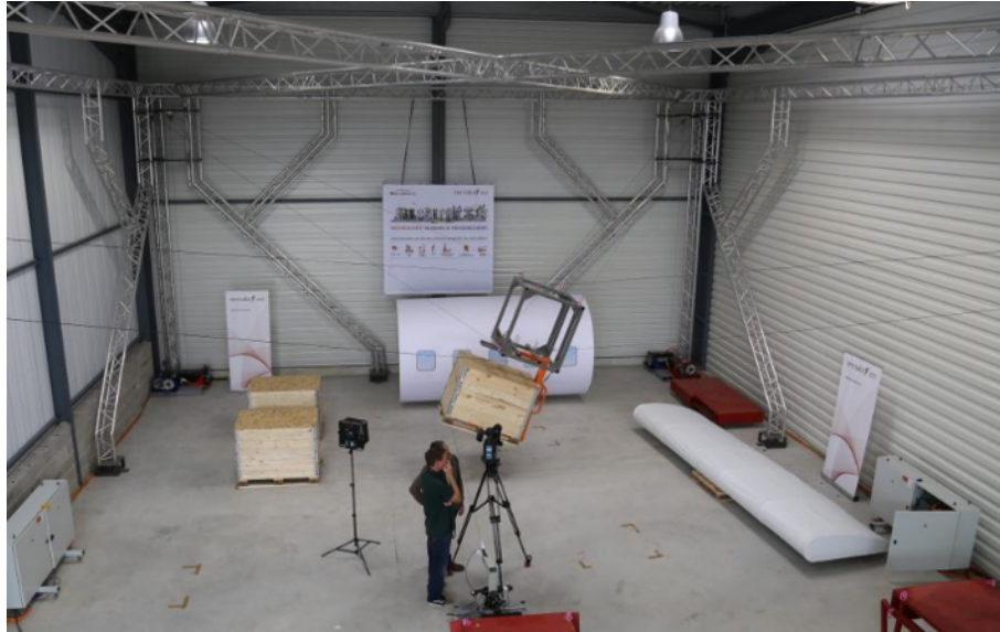
Figure 2 – Le robot CoGiRo (LIRMM-Tecnalía)
