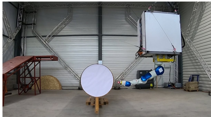
Figure 5 – Scénario de peinture de fuselage par CoGiRo dans le cadre du projet ANR DexterWide (LIRMM-Tecnalia) [2]
