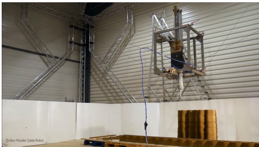
Figure 1.9 – Le RPC CoGiRo imprimant un mur [5]
