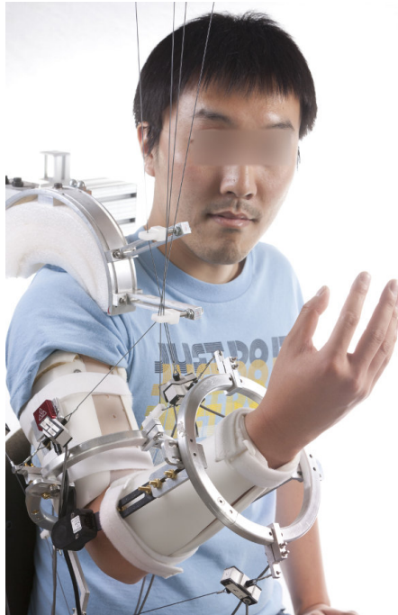
Figure 1.6 – L'exosquelette à câbles Carex [3]
