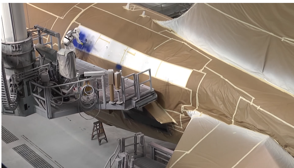
Figure 6.1 – Peinture d'un fuselage d'avion par un ouvrier [9]
