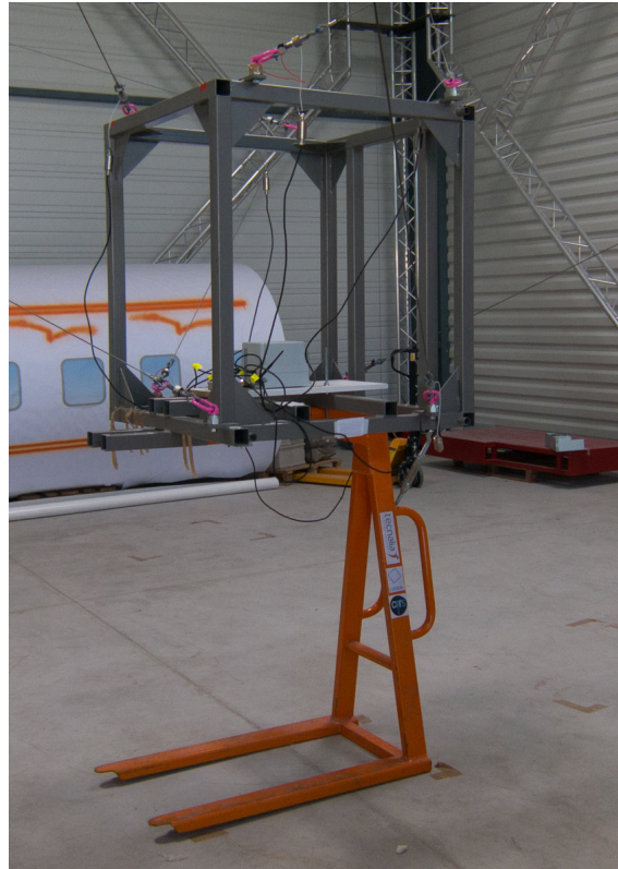
Figure 4 – La plateforme mobile de CoGiRo dotée d'une fourche de grue (LIRMM-Tecnalia)
