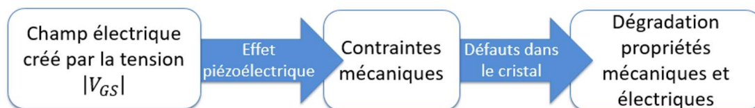
Figure 34 : Schéma de l'effet piézoélectrique inverse
