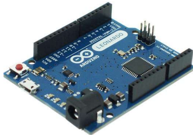
Figure 79 : Carte Arduino Leonardo utilisée pour programmer les signaux de commande de grille
