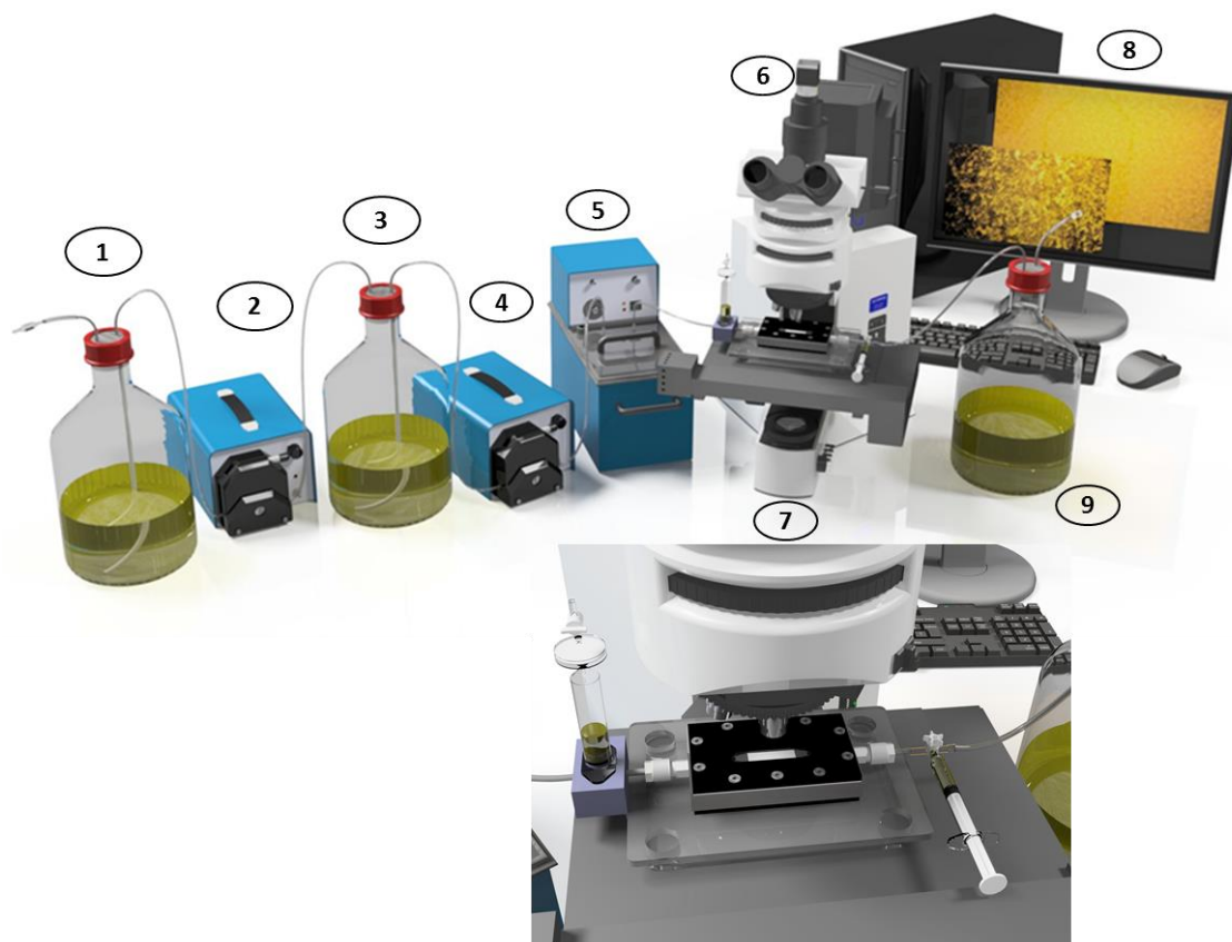
Figure 20 : Schéma du dispositif expérimental pour l'étude des biofilms de L. lactis en conditions d'écoulement. (1) et (3) : réservoirs de stockage du milieu de culture avec leurs pompes respectives (2) et (4). (5) : bain-marie dans lequel baigne le tuyau d'alimentation. (6) : microscope à fluorescence avec caméra. (10) : chambre d'écoulement (7) : dispositif d'inoculation : piège à bulle, vanne et seringue d'injection. (8) : ordinateur connecté à la caméra. (9) : réservoir à déchets.
