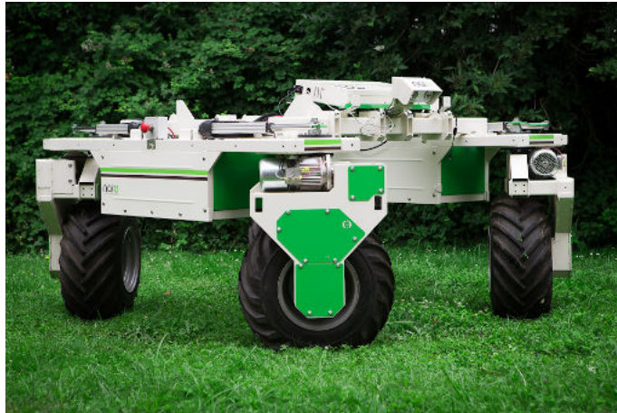
Figure 5.1: Robot Dino, avec ses roues orientées (Crédit Tien TRAN)
