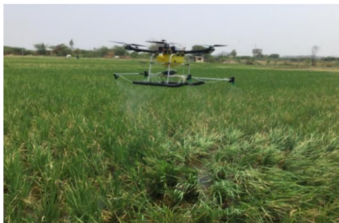
Figure 1.3: Drone pulvérisant un pesticide
