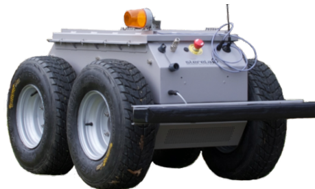
Figure 4.1: Base robotique 4MOB de Sterela (Crédit Matthieu Herrb)
