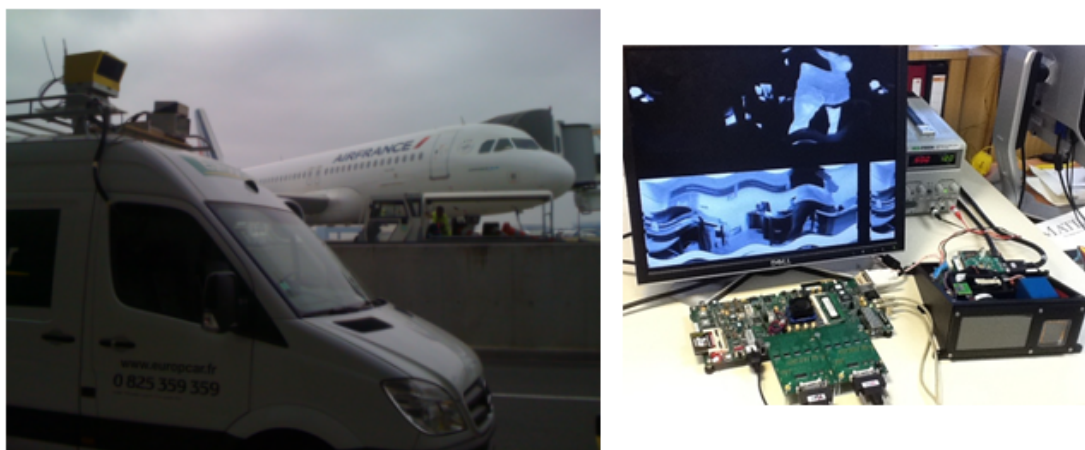
Figure 2.1: Intégration matérielle réalisée dans le cadre du projet SART : à gauche la campagne de mesures réalisée sur l'aéroport de Blagnac avec les capteurs montés sur un camion et à droite le boîtier des caméras VIS/LWIR (long wavelength infrared) et kits de développement sur FPGAs.
