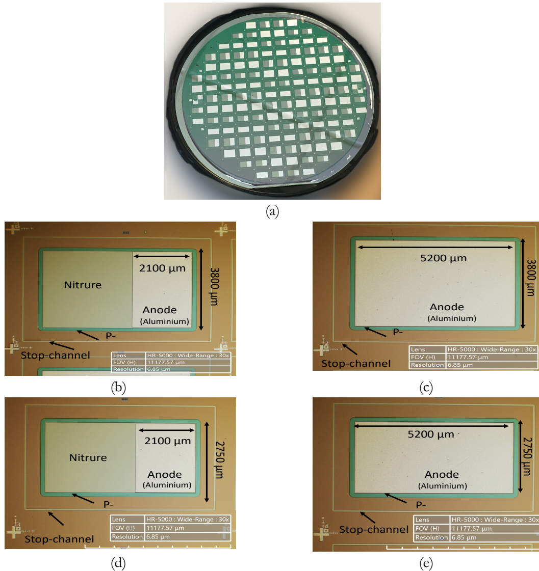
Figure 85 : Diodes réalisées en salle blanche du LAAS, wafer 4 pouces (a), prototype à 3 constrictions et pad anode partiel (b), prototype à 3 constrictions avec pad anode complet (c), prototype à 2 constrictions avec pad anode partiel (d) et prototype à 2 constrictions avec pad anode complet (e)
