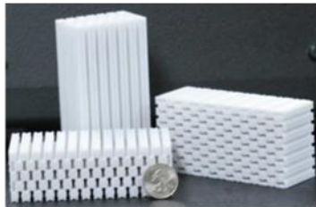
Figure I.13 : Matériaux réalisés à l'aide de la fabrication additive et permettant la variation de la permittivité et d'obtenir un matériau anisotrope
