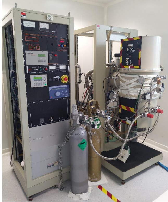
Figure A-3 : Bâti de dépôt Alcatel CIT.
