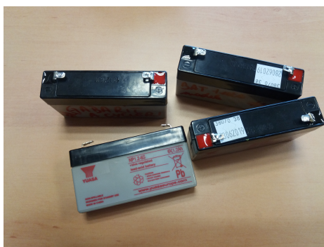
FIGURE 1 – Photographie des 4 VRLAB Yuasa testées
