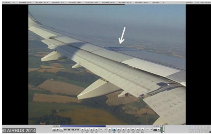
Figure 36. Photo de l'aile de l'A321 sur laquelle sont installés le récupérateur d'énergie et la ceinture de capteurs, vue prise à 7h08 GMT+1.
