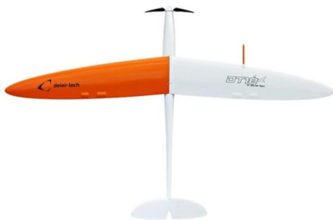
Figure 48. Drone DT-18 (2kg, envergure 1,8m, autonomie 100km ou 2h )
