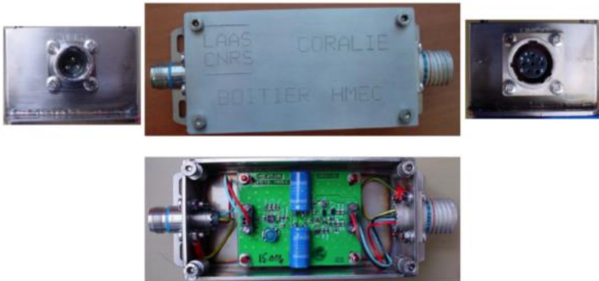
Figure 103. Photo du boîtier avec vue des connecteurs et de la carte électronique.
