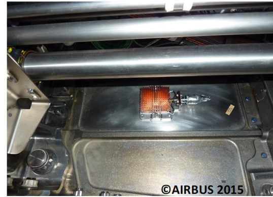
Figure 89. Implémentation du module TEG sur l'A380 MSN1: (a) rappel des zones concernées. (b) module TEG positionné et fixé (sans le câble de connexion).
