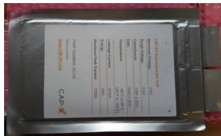
Figure 3. supercondensateur Cap-XX de forte valeur conditionnement plat (photo VB)
