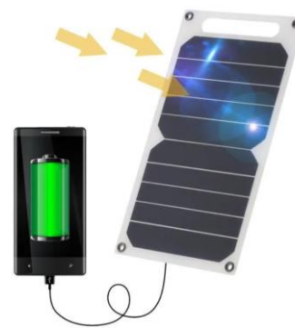
Figure 11. Chargeur de téléphone solaire. 10\text{Wc} [5]
