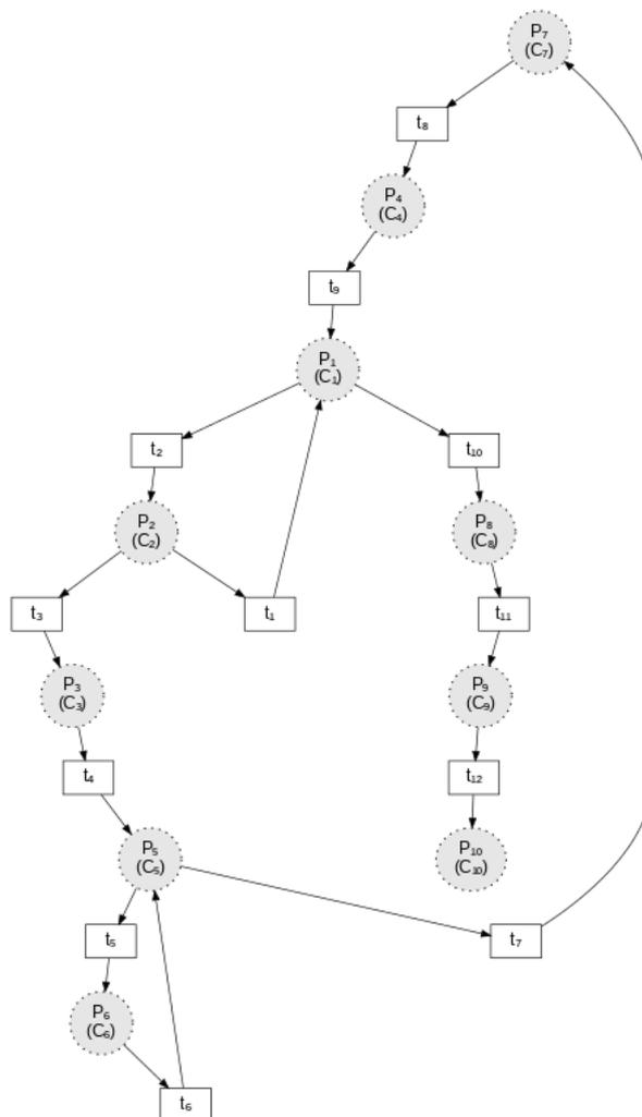
FIGURE 5.20 – Représentation structurelle du HtPN appris avec réapprentissage
