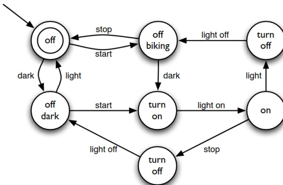
FIGURE 1.1 – Exemple de SED : un automate (VERWER et al. 2006)
