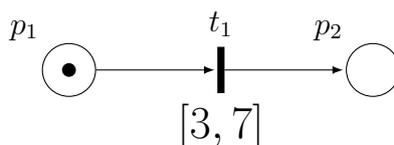
FIGURE 6.1 – Exemple d’un Réseau de Petri temporel
