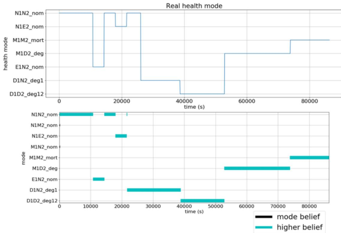
FIGURE 5.11 – Simulation et diagnostic pour le scénario 4 (nominal, fautes fatales et usure des panneaux)
