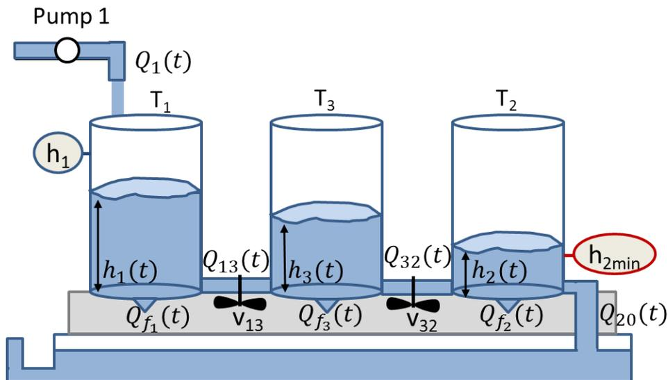
FIGURE 2.7 – Représentation du système des trois cuves
