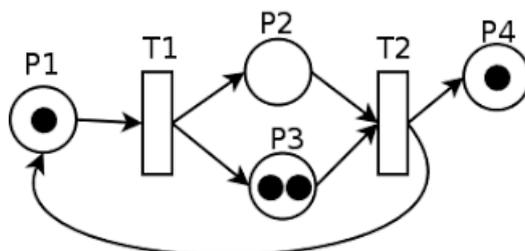
FIGURE 1.2 – Exemple de SED : un réseau de Petri
