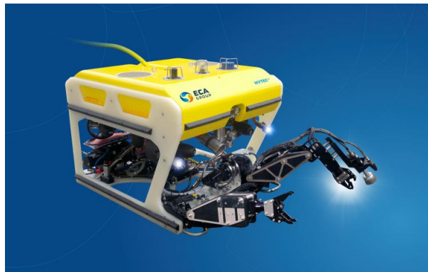
FIGURE 2.11 – Le robot téléguidé H1000 de ECA, peut être utilisé pour identifier et neutraliser des mines.
