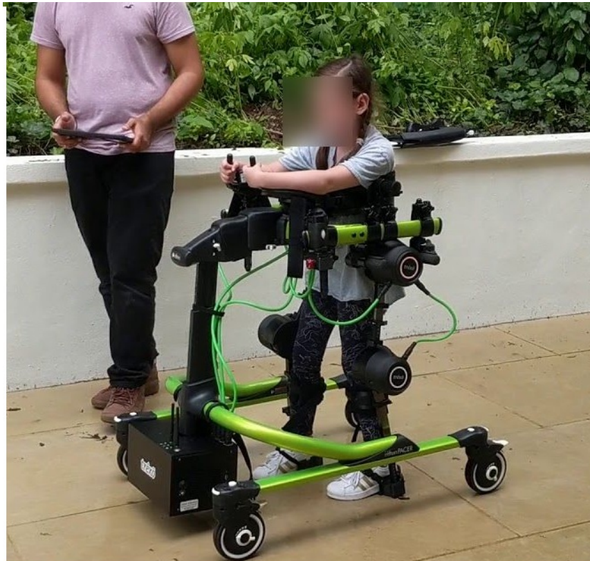
Figure 6.2 – Dispositif Trexo Plus composé de la partie déambulateur et de la partie exosquelette.
