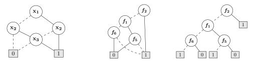
Figure C.2: Un exemple illustrant le BDD de profondeur 3.
