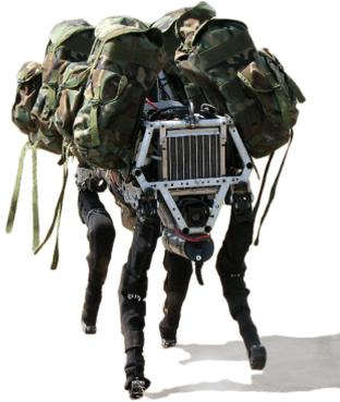
FIGURE 3 – Robot quadrupède BigDog de Boston Dynamics
