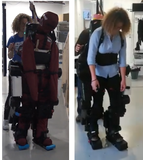
FIGURE 37 – Expériences de marche avec mannequin et patient valide. Lien pour des vidéos : [Vid]
