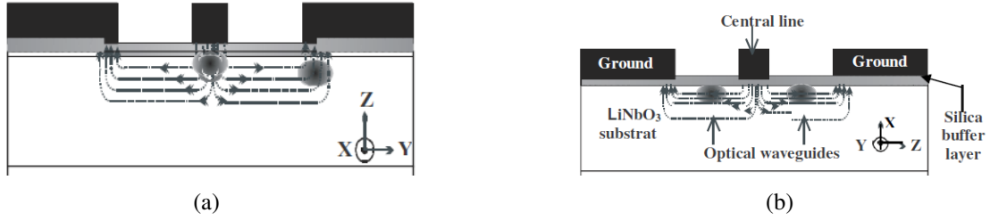
FIGURE 2.15 – Vue en coupe d'un MZM : a) z-cut b) x-cut [14]
